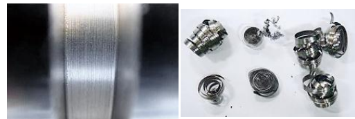
图. SCM415 割槽加工面和切削的比较
